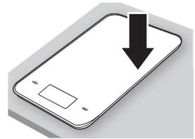
2. Berühren Sie die Taste **ON/OFF**, um die Waage einzuschalten. In der LCD-Anzeige erscheint das Dreiecksymbol ▲, das 0-Symbol --0--, sowie die Gewichtseinheit "g". Das Dreiecksymbol ▲ zeigt an, dass das Gewicht abgelesen und das Wägegut auf die Wiegefläche gelegt werden kann. Das 0-Symbol --0-- zeigt an, dass die Waage zum Wiegen bereit ist.
