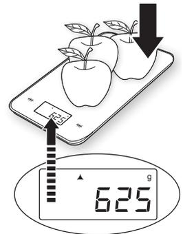
4. Bei Überladung der Waage, erscheint "EEEEEE" in der LCD-Anzeige. Es können maximal 5000 g gewogen und angezeigt werden.
