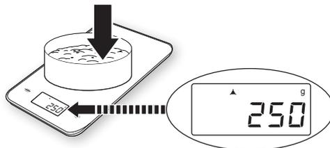
4. Berühren Sie die Taste **TARE** erneut, um die Waage wieder auf "0" zu stellen. Geben Sie die nächste Zutat in den Behälter. Fahren Sie auf die gleiche Weise fort, bis alle Zutaten in den Behälter gegeben wurden.
